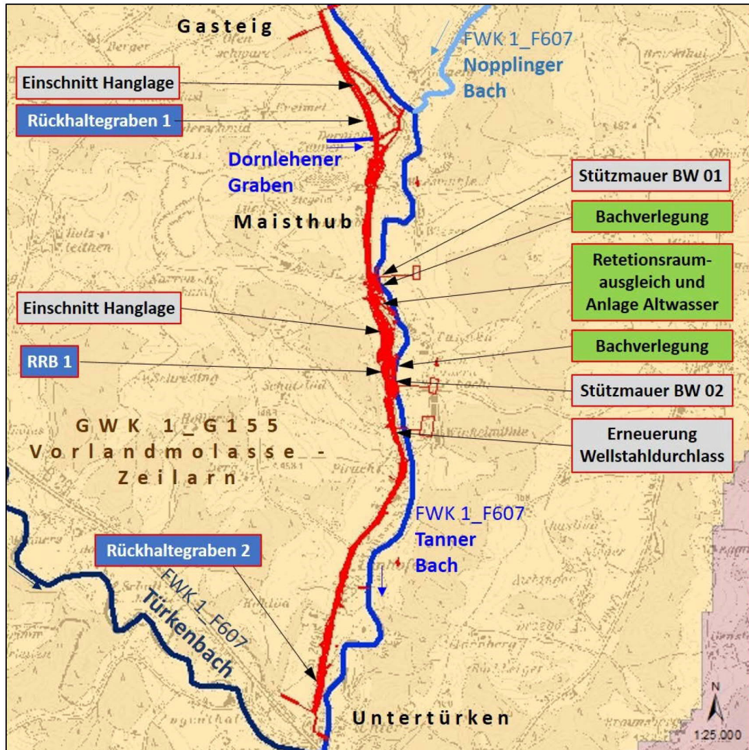
Abb. 3: Ausbau der St 2090 südlich von Tann: Geplanter Trassenverlauf und Übersicht der geplanten Maßnahmen (blau: Entwässerungsanlagen, grau: Ingenieurbauwerke, grün: Gewässerbau)
