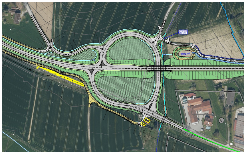
Abbildung 12: Teilplanfreier Knotenpunkt - Plantrasse liegt dem Feststellungsentwurf zugrunde
