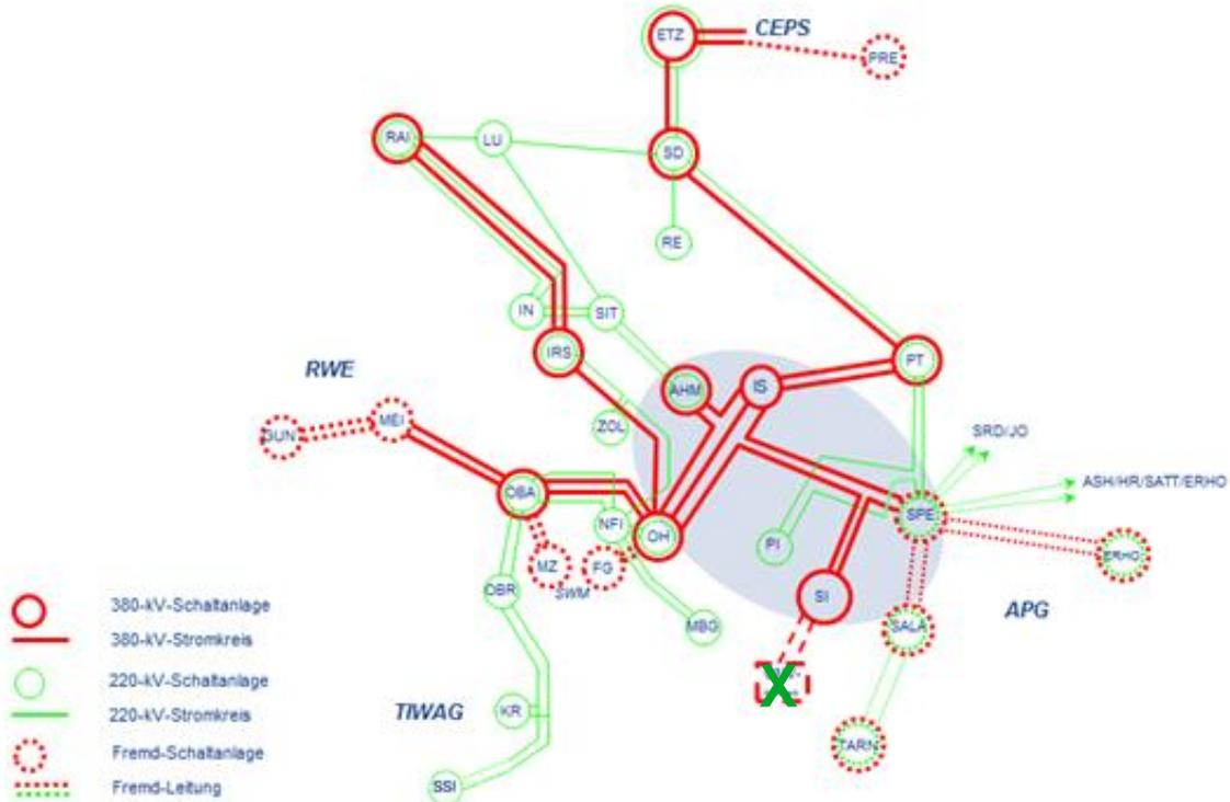
Abbildung 5: Netztopologie nach Fertigstellung der Leitungen 380-kV Leitungen Altheim – Matzenhof mit Teilabschnitt 1 Altheim – Adlkofen und (St. Peter-) Landegrenze – Simbach
