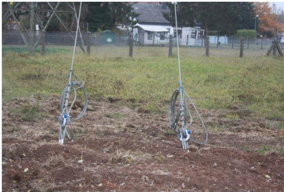
Abbildung 18: Bsp. ins Erdreich eingebrachte Abankerungen
